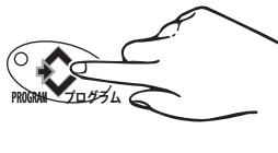
1. 请边按着程序键 (PROGRAM), 边打开缝纫机的电源。
