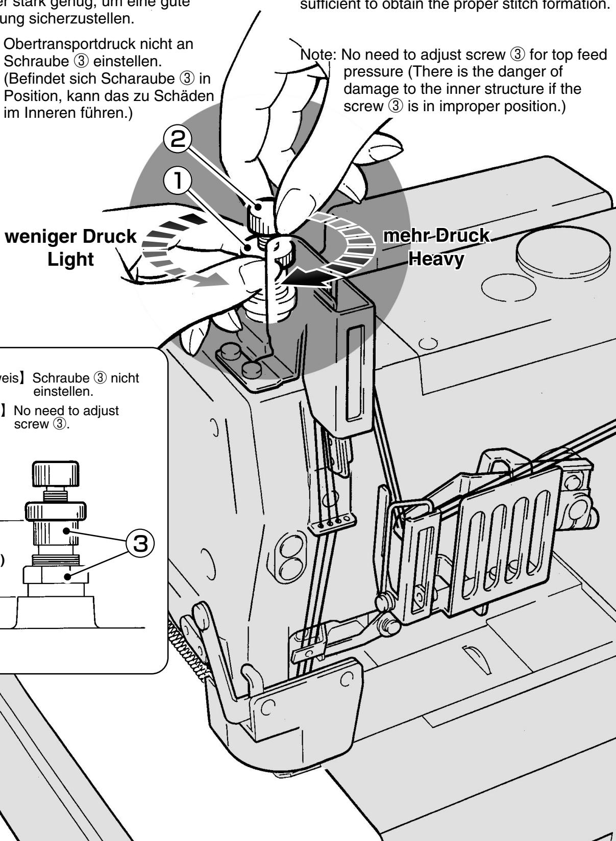
Mutter ① lösen und mit Schraube ② die Transportdifferenzierung einstellen.
