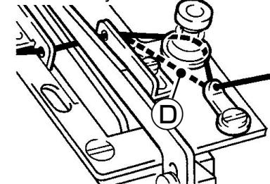
Réglage par rotation de la vis réglage ② après avoir desserré l'écrou ①.
