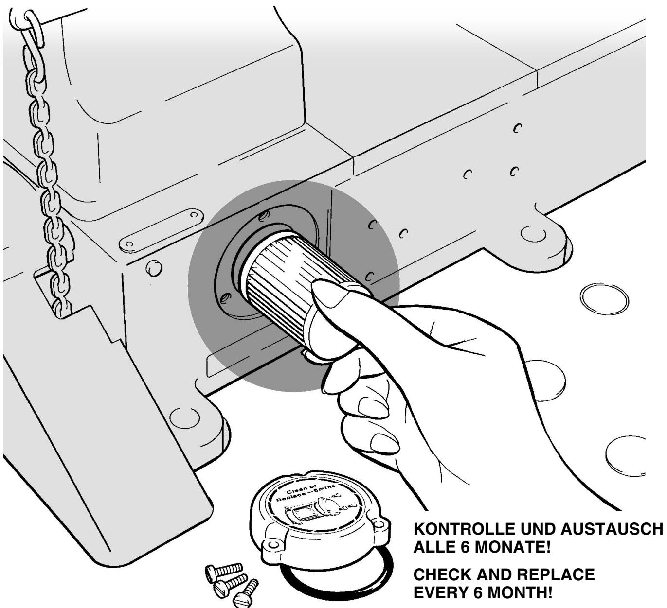
Hinweis : Bei Maschinen mit Fadenschneideeinrichtung muß hierzu der Magnethalter abgebaut werden.
