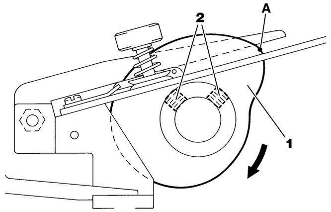
**Position de la pointe de l'aiguille gauche quand le fil de boucleur saute au point A du releveur du fil de boucleur 1.**
