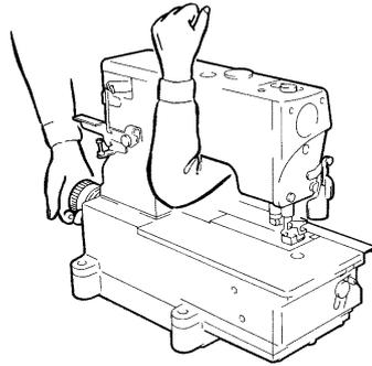
3. Pendant le transport avec la charrette à bras et pendant le montage de la machine sur le plateau, évitez les chocs et les secousses, qui pourraient faire tomber la machine.
