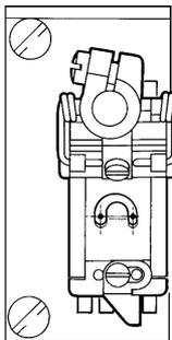
● Vérifiez la bonne fixation du pied presseur en le relevant à l'aide du relève-pied et en essayant de le décaler vers l'avant, l'arrière et sur les côtés.
