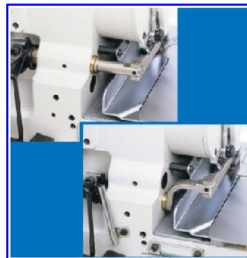
*Hochposition wird bei Maschenware und Jeans verwendet. Niederposition wird für Webware verwendet um Nahtkräuseln zu reduzieren.*
