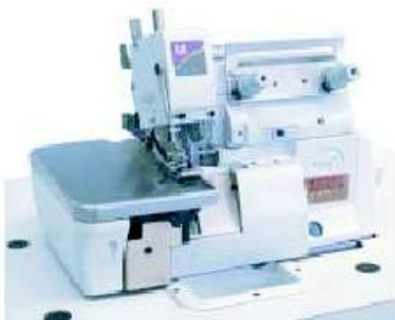
Diese neu entwickelte Unterklasse eignet sich zum Zusammennähen von Stoffbahnen in der Färberei und Ausrüstung mit einer breiten Naht von 6 mm, welche geöffnet eine Nahtbreite von 12 mm ergibt.
